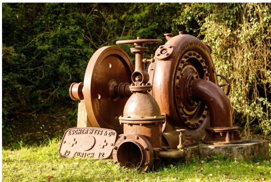
Figura 11 – Lanifício São Pedro, atual Cootegal. Destaque para a turbina Suíça para produzir energia elétrica - um vestígio de patrimônio industrial - 2025
